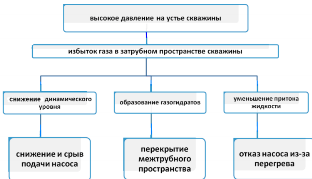
Рисунок 12 - Осложнения, возникающие при работе насосного оборудования в скважинах с высоким газовым фактором
