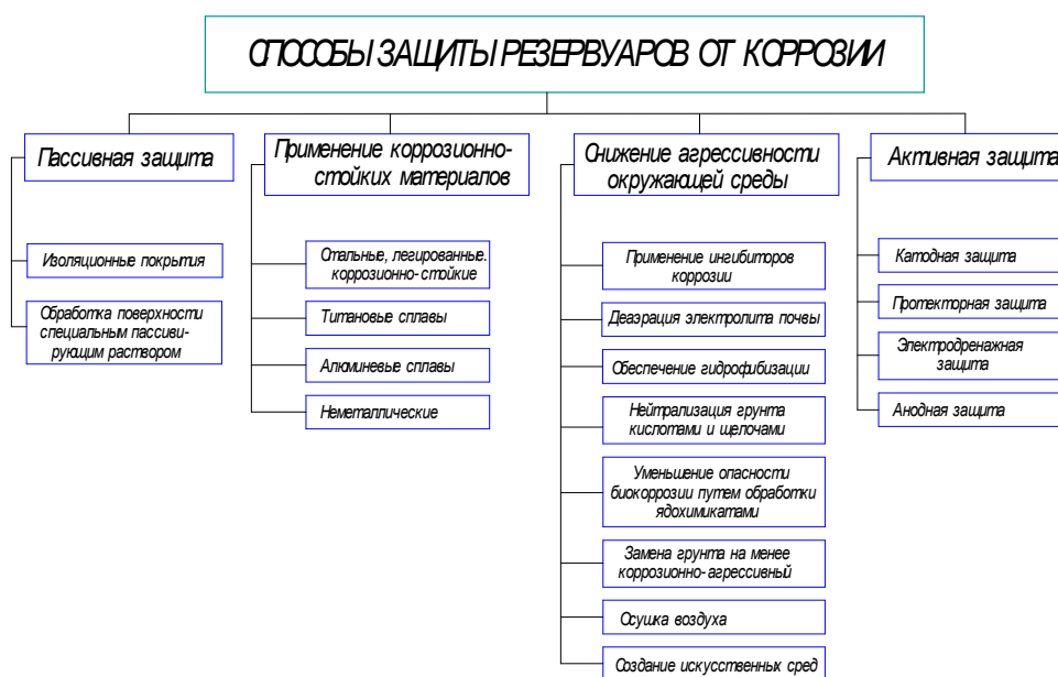
Рисунок 1 – Классификация способов защиты резервуаров от коррозии
