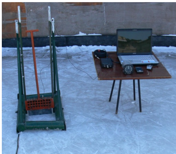
Рис. 2. Стенда для исследования ударного разрушения снежно-ледяных образований.
