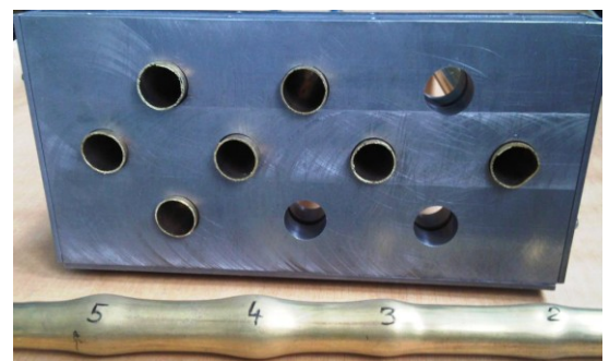
Рис. 2. Запрессовка в макет двойной решетки
