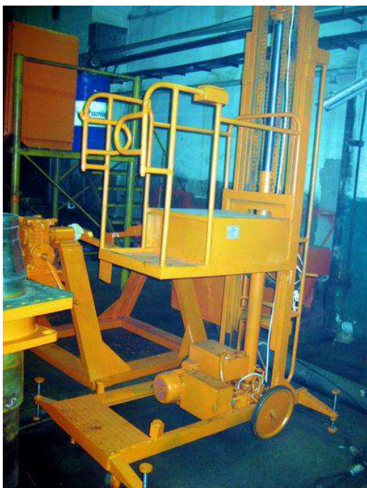
Рисунок 2.7 – Устройство передвижное с площадкой для обслуживания а/м БелАЗ, ПТ-106
