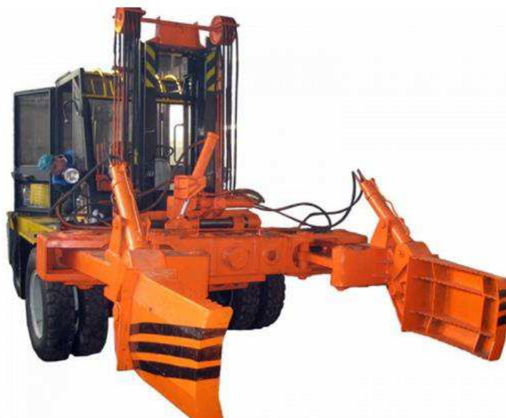
Рисунок 2.6 – Навесное устройство для снятия и установки колес 31-67
