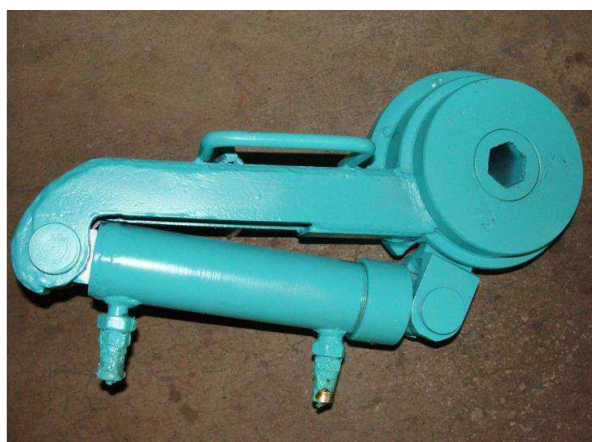
Рисунок 2.9 – Ключ гидравлический Р-03 для отворачивания башмачных болтов и гаек
