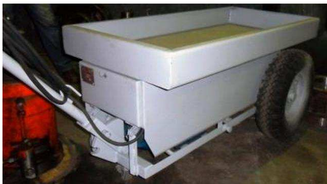
Рисунок 2.10 – Маслостанция с электроприводом ТР-06
