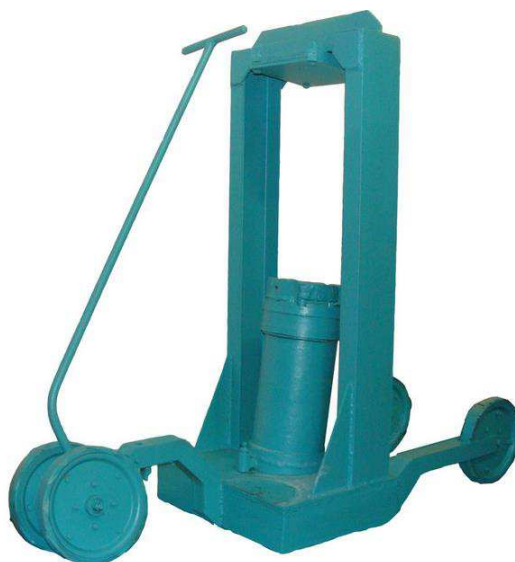
Рисунок 2.4 – Механизм выбивки шкворня поворотного кулака передней оси 30-09
