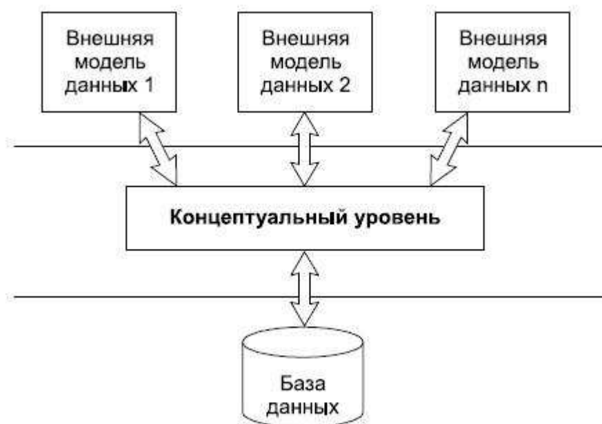
Рисунок 1.3 – Схема трехуровневой модели системы управления базами данных, предложенной ANSI
