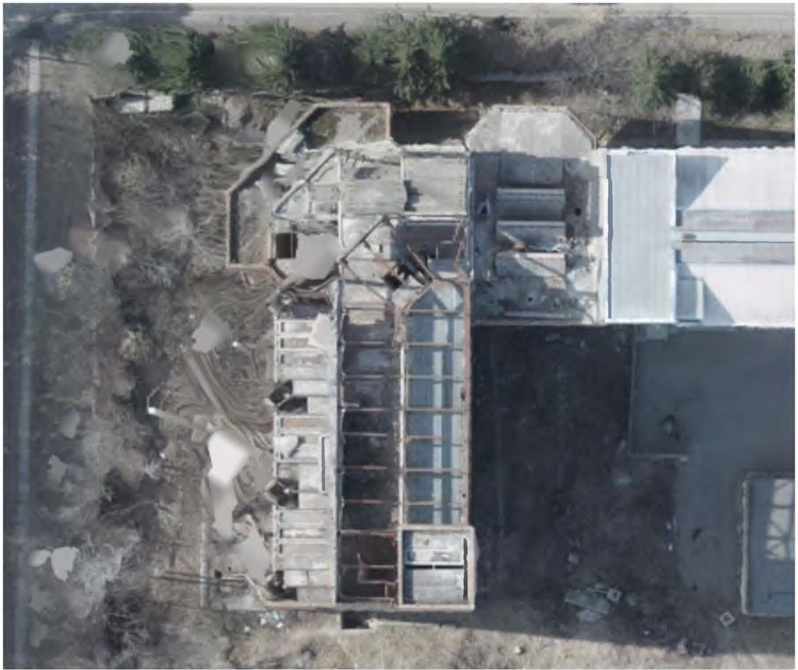
Рисунок 11 – Искажение на ортофотоплане
