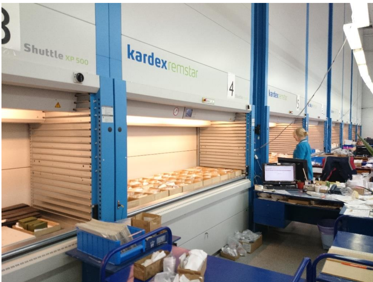
Рисунок 10 – Помещение центрального комплекточного цеха после внедрения АСК Kardex Shuttle XP
