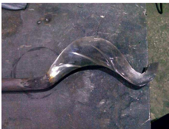
Рисунок 41 – Приваренный хвост к основе подвеса
