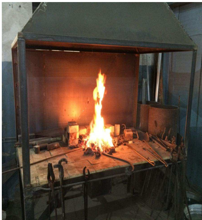
Рисунок 9—Стационарный одно-огневой металлический горн открытого типа
