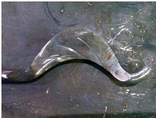
Рисунок 42 – Готовый хвост основы подвеса
