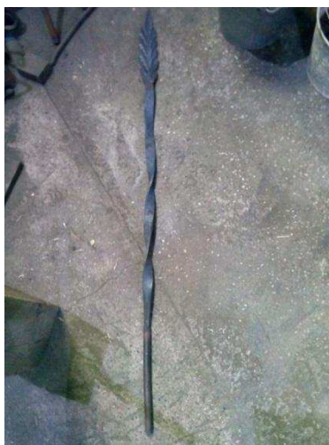
Рисунок 38 – Заготовка основы подвеса
