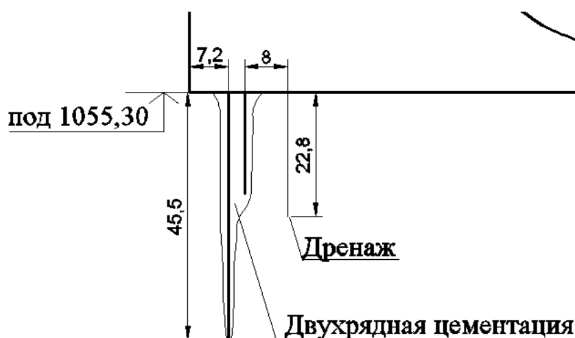
Рисунок 4.2 – Схема расположение вертикальной двухрядной цементации и вертикального дренажа
