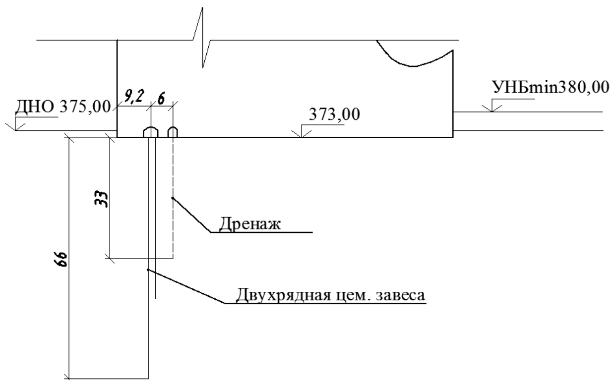
Рисунок 5.4 - Подземный контур водосливной плотины
