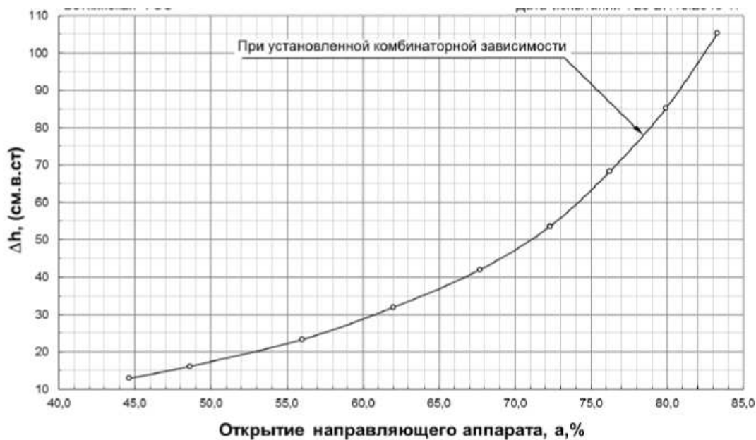
Рисунок 18 – зависимость перепада давления по турбинному расходомеру агрегата от открытия направляющего аппарата
