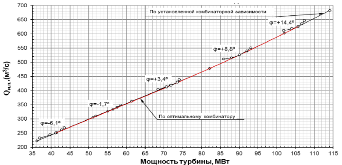
Рисунок 8 – зависимость индексного расхода турбины от мощности турбины
