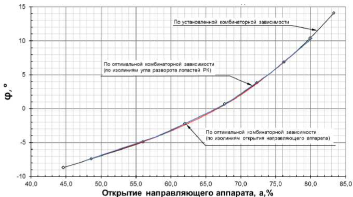
Рисунок 19 – комбинаторные зависимости для агрегата
