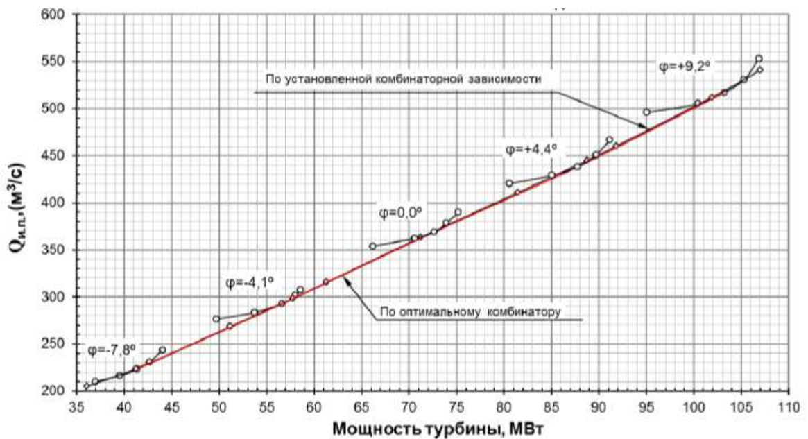
Рисунок 26 – зависимость индексного расхода турбины от мощности турбины
