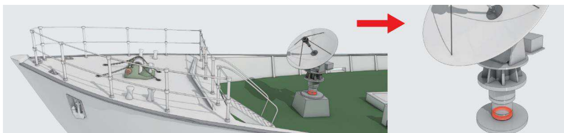
Рисунок 24 – Установка подшипника в привод поворота антенны
