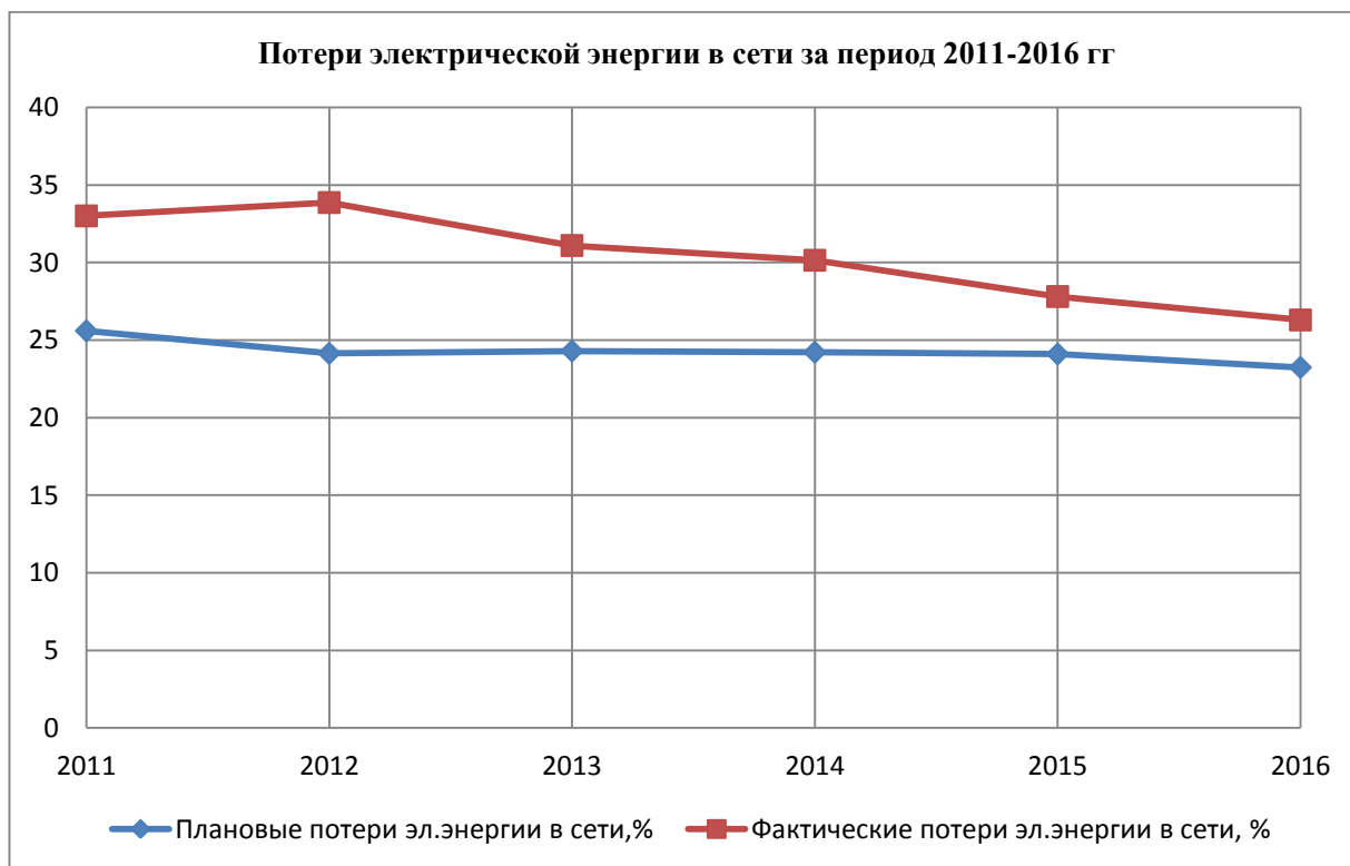
Рисунок 5 – Потери электрической энергии в сети
