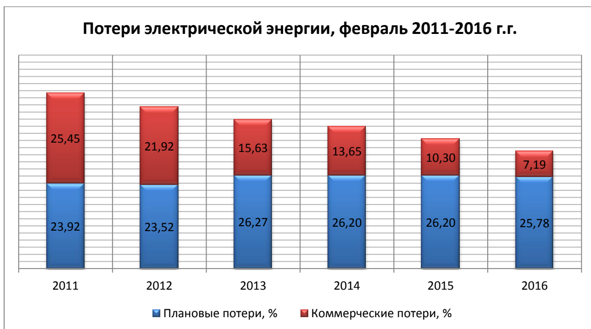
Рисунок 18 – Потери электроэнергии на ПС №34, февраль 2011-2016 г.г.
