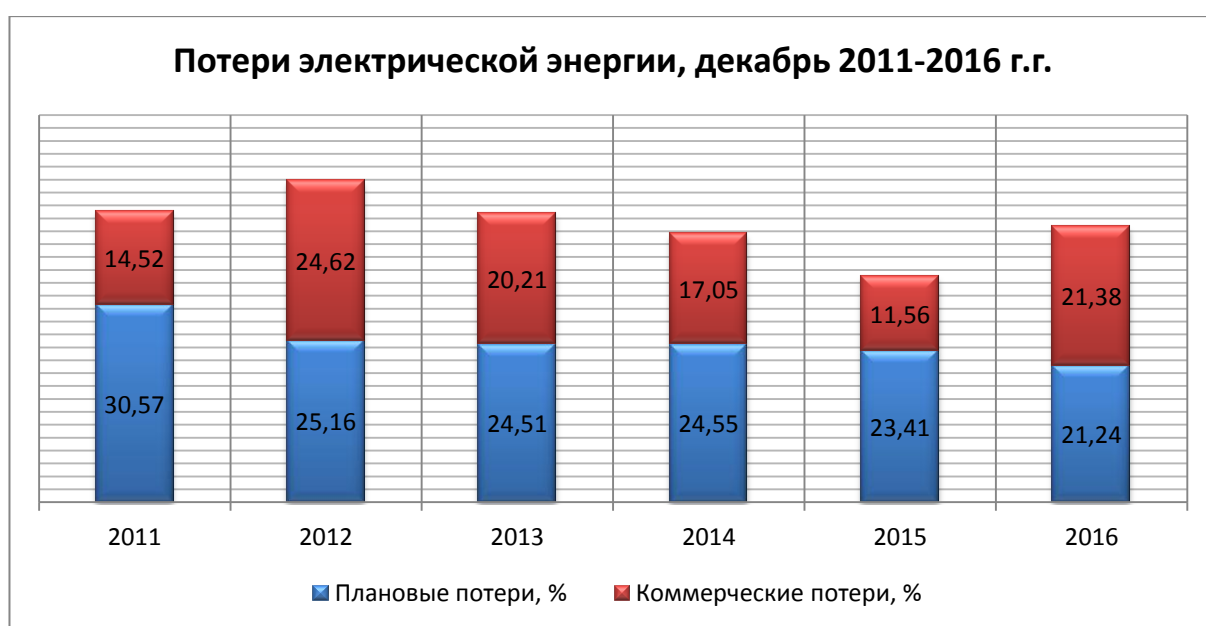
Рисунок 22 – Потери электроэнергии на ПС №34, декабрь 2011-2016 г.г.
