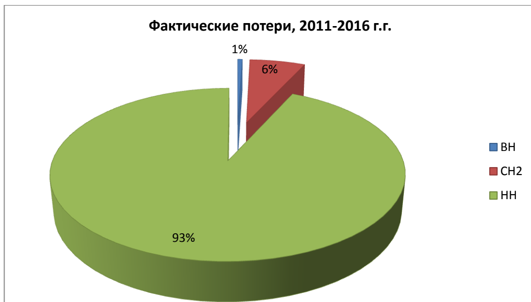
Рисунок 23 – Потери ПС №34 «Насосная»
