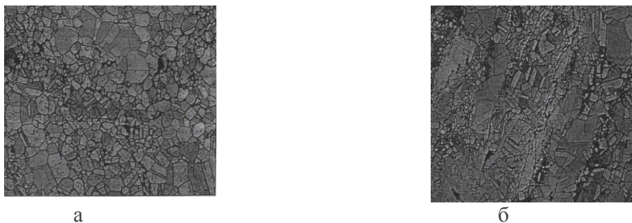
Рис. 3. Микроструктура прессованного полуфабриката из неотожжённой медной стружки с добавкой БрОЦС4-4-2,5: а) 10% БрОЦС4-4-2,5; б) 20% БрОЦС4-4-2,5
