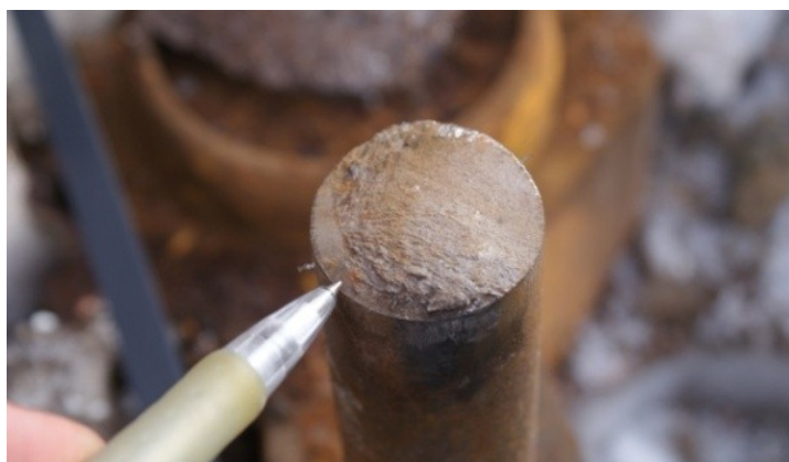
Рис. 6. Усталостная трещина болта
