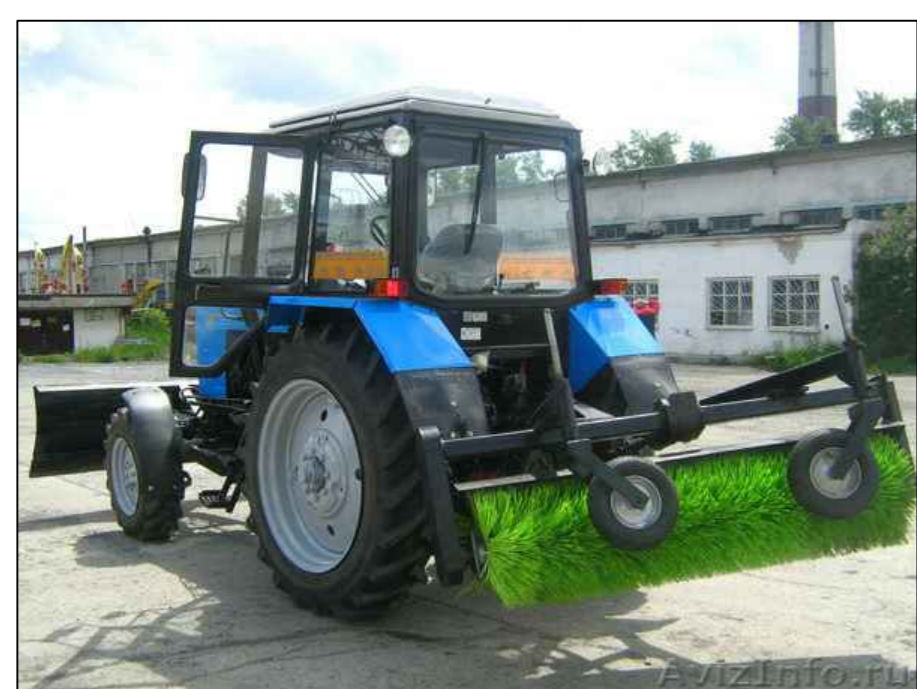
Рисунок 2 – Трактор (Беларусь) МТЗ-82.1 с навесным оборудованием (щеткой), чистка проезжей части
