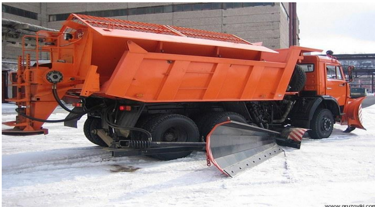
Рисунок 8.2 – КАМАЗ (ДМК) 40.02 с передним скоростным и боковым отвалами
