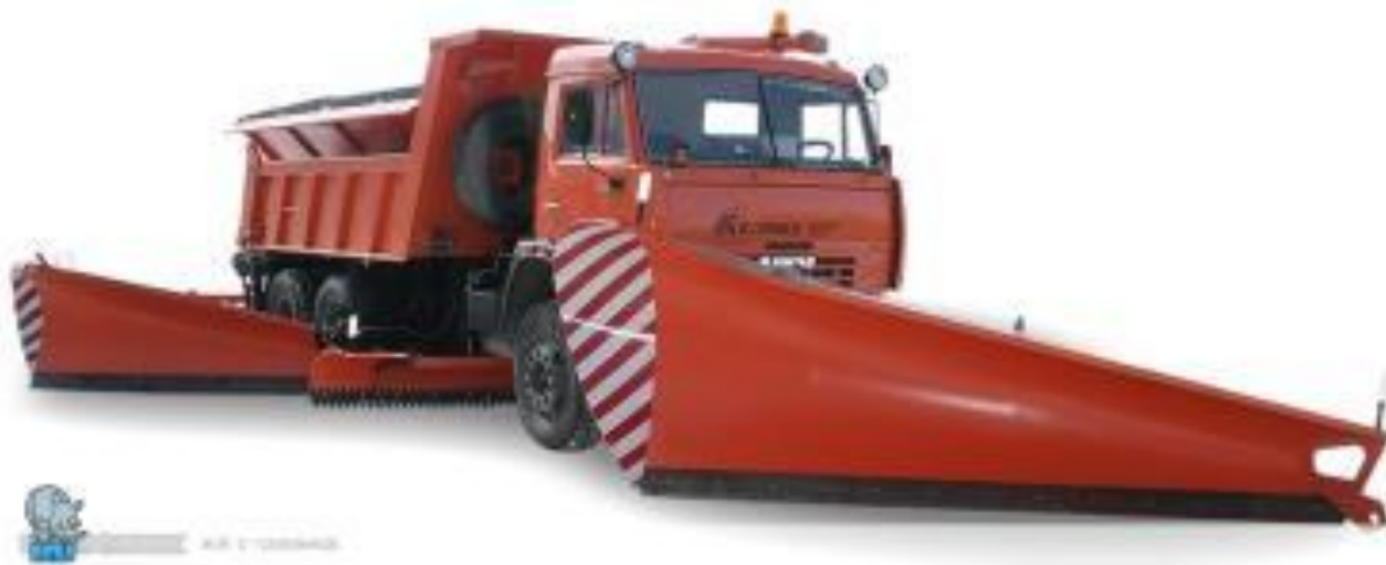
Рисунок 7.2 – ДМК 40.02 с передним, средним и боковым отвалами
