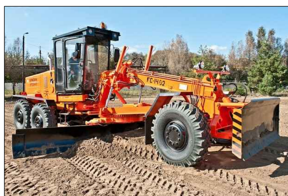
Рисунок 3 – Автогрейдер ГС-14.02, планировка проезжей части и обочин
