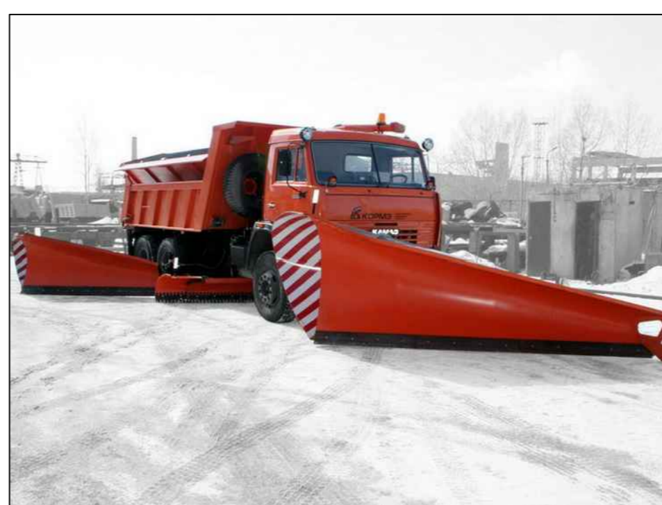
Рисунок 5 – Комбинированная дорожная машина ДМК 4.0.02, с передним скоростным, средним и боковым отвалами
