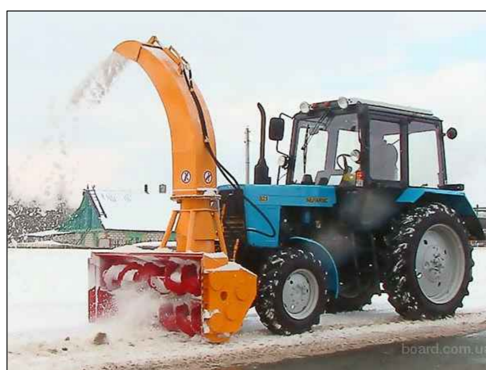
Рисунок 6 – Трактор (Беларусь) МТЗ-82.1 с навесным оборудованием шнекоротором
