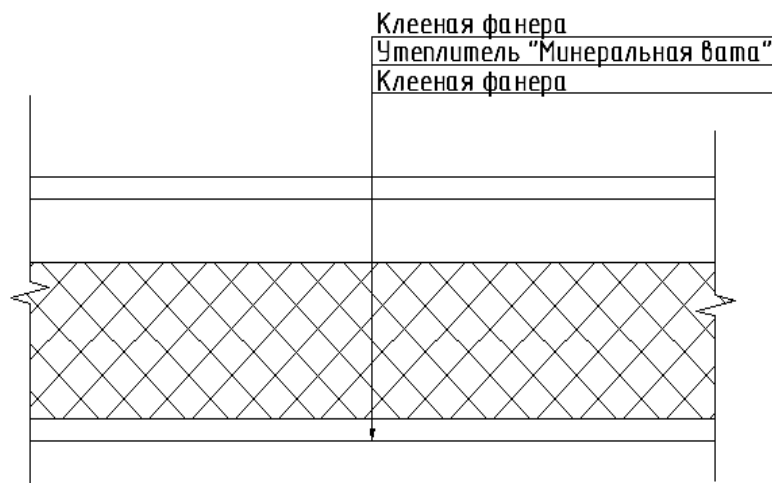
Рисунок 1.4 – Плита перекрытия, разрез
