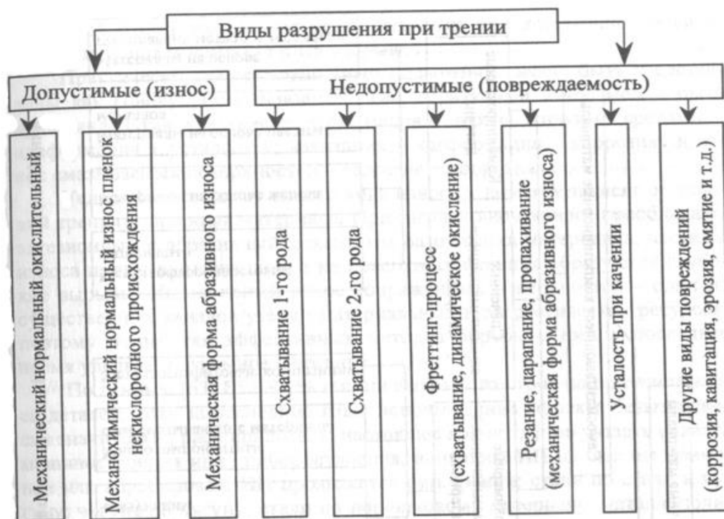
Рис. 6. Классификация видов разрушения при трении
