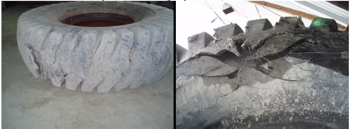
Рисунок 7.3 - Отслоение и вздутие протектора
