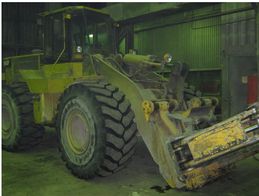
Рисунок 7.19 - Погрузчик САТ 966F
