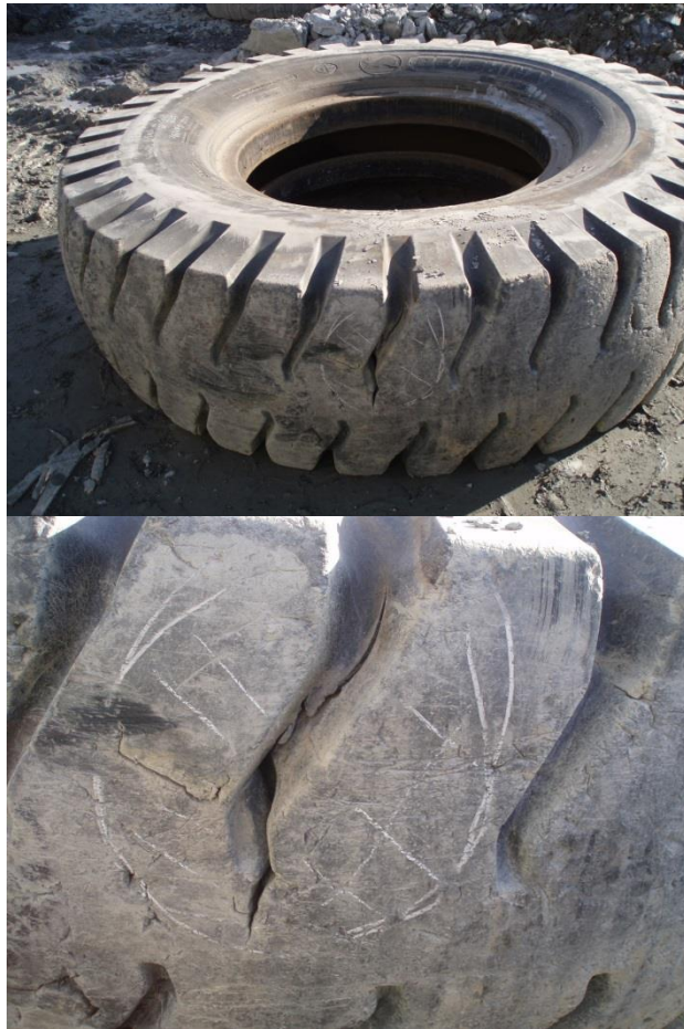
Рисунок 7.2 – Пробой шины - отслоение и вздутие - 26,1 % (рисунок 7.3)
