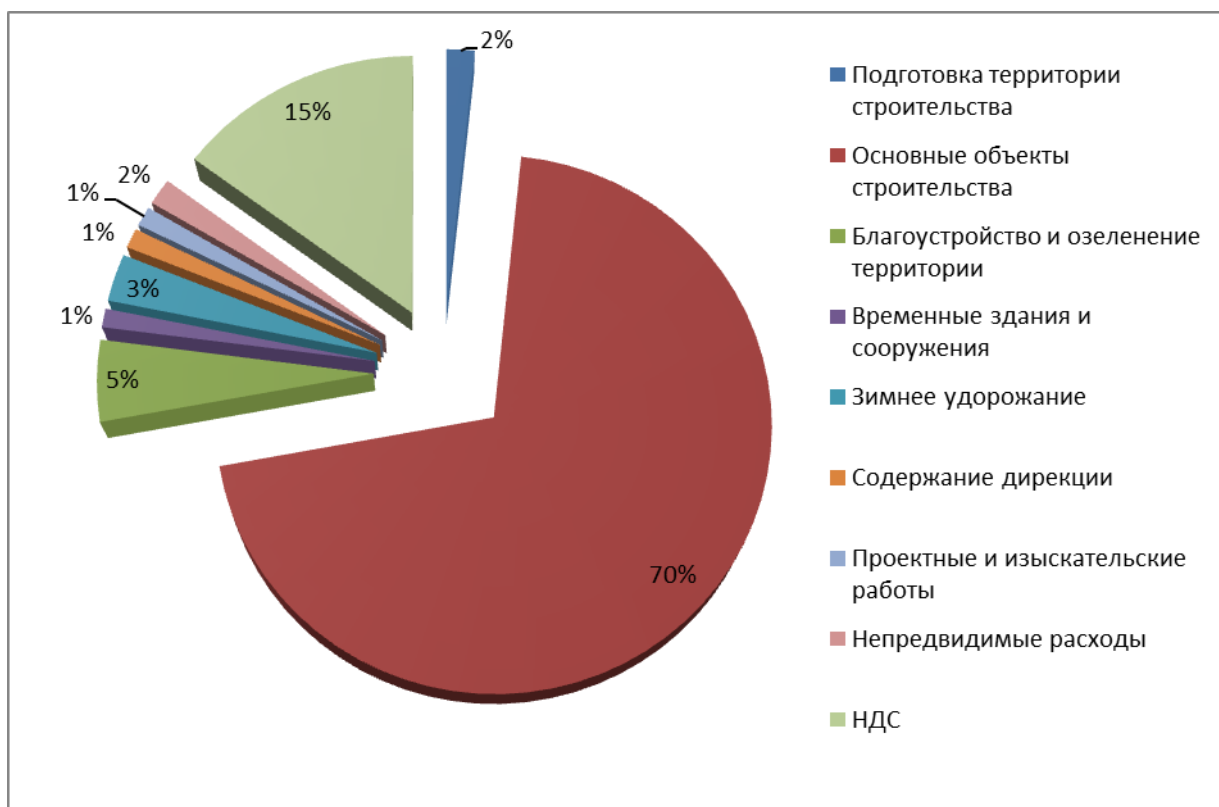
Рисунок 8.4 - Представлена структура сводного сметного расчета на строительство пожарного депо на два автомобиля в г. Железногорске
