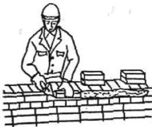
Рисунок 6.13 – Кладка наружной версты ложкового ряда
