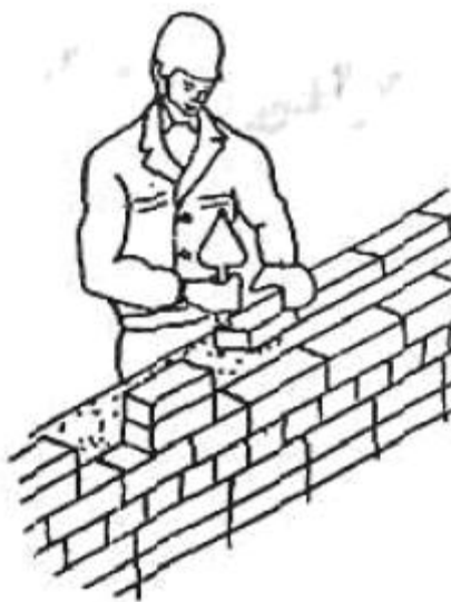
Рисунок 6.11 – Кладка внутренне версты ложкового ряда
