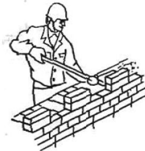
Рисунок 6.10 – Раскладка раствора для внутренней версты ложкового ряда
