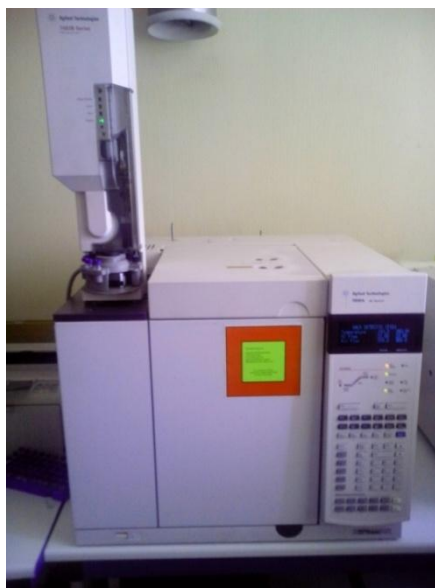
Рисунок 6 – Газовый хроматограф ALIGENT 7890А (фото автора).
