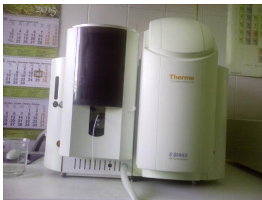
Рисунок 7 –Атомно-абсорбционный спектрофотометр AASolaar модель S2 AASystem (фото автора).
