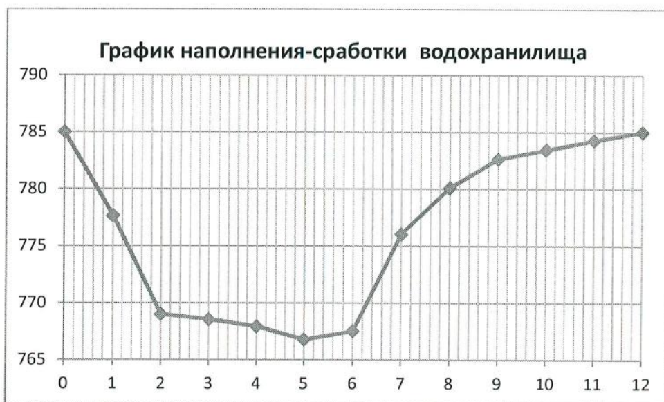
Рисунок 2.8 - График изменения отметки верхнего бьефа
