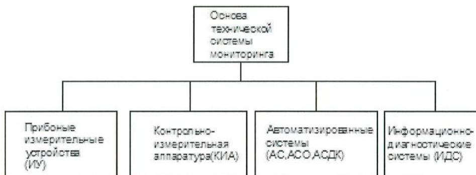
Рисунок 8.1 - Состав технической системы мониторинга ГТС
