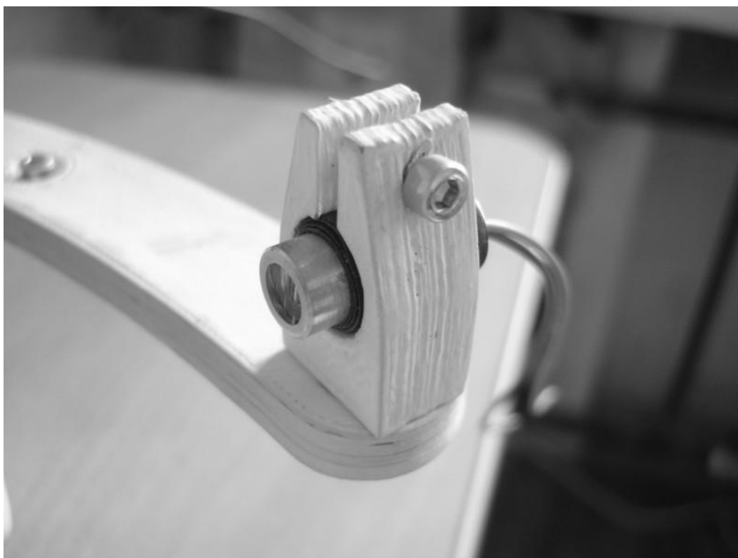
Рисунок 14—Пластиковое крепление лазерного модуля, зафиксированное на раме
