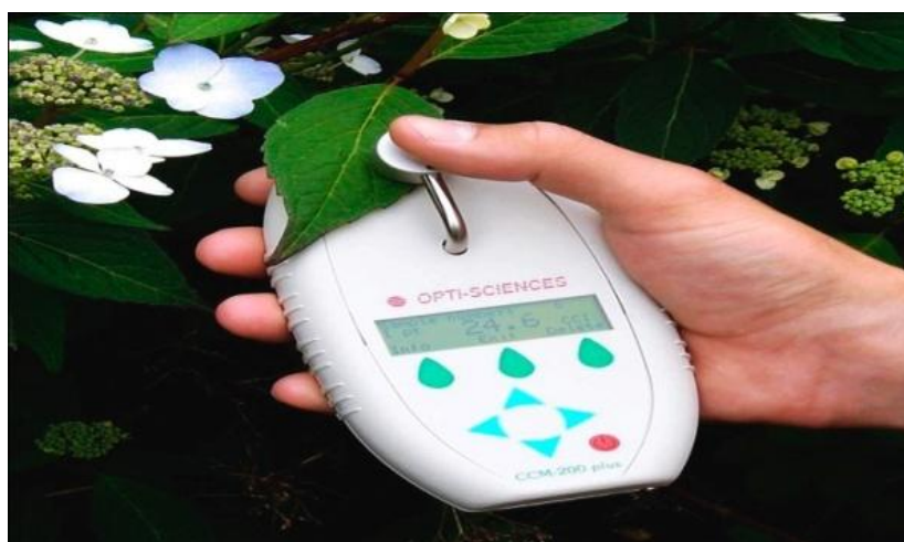
Рисунок 2 - Прибор ССМ-200 plus для измерения концентрации хлорофилла в листе дерева
