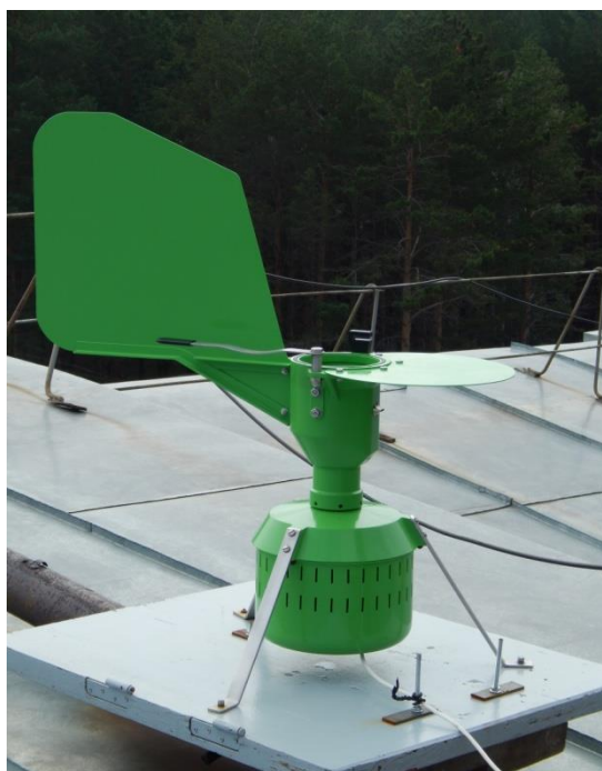
Рисунок 7- Ловушка Буркарда, установленная на крыше Сибирского федерального университета (фото автора)
