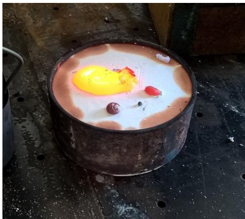
Рисунок 18 - Заливка металла в подготовленную форму
