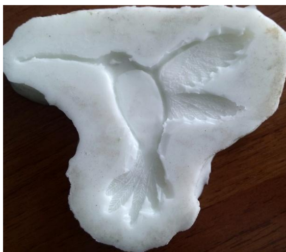
Рисунок 13 - Пресс-форма из пентэласта-9121
