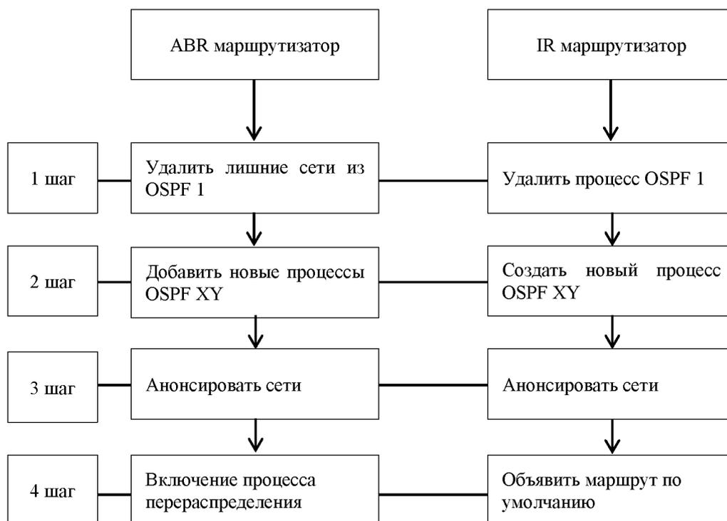
Рисунок 13 – Алгоритм оптимизации перераспределения информации
