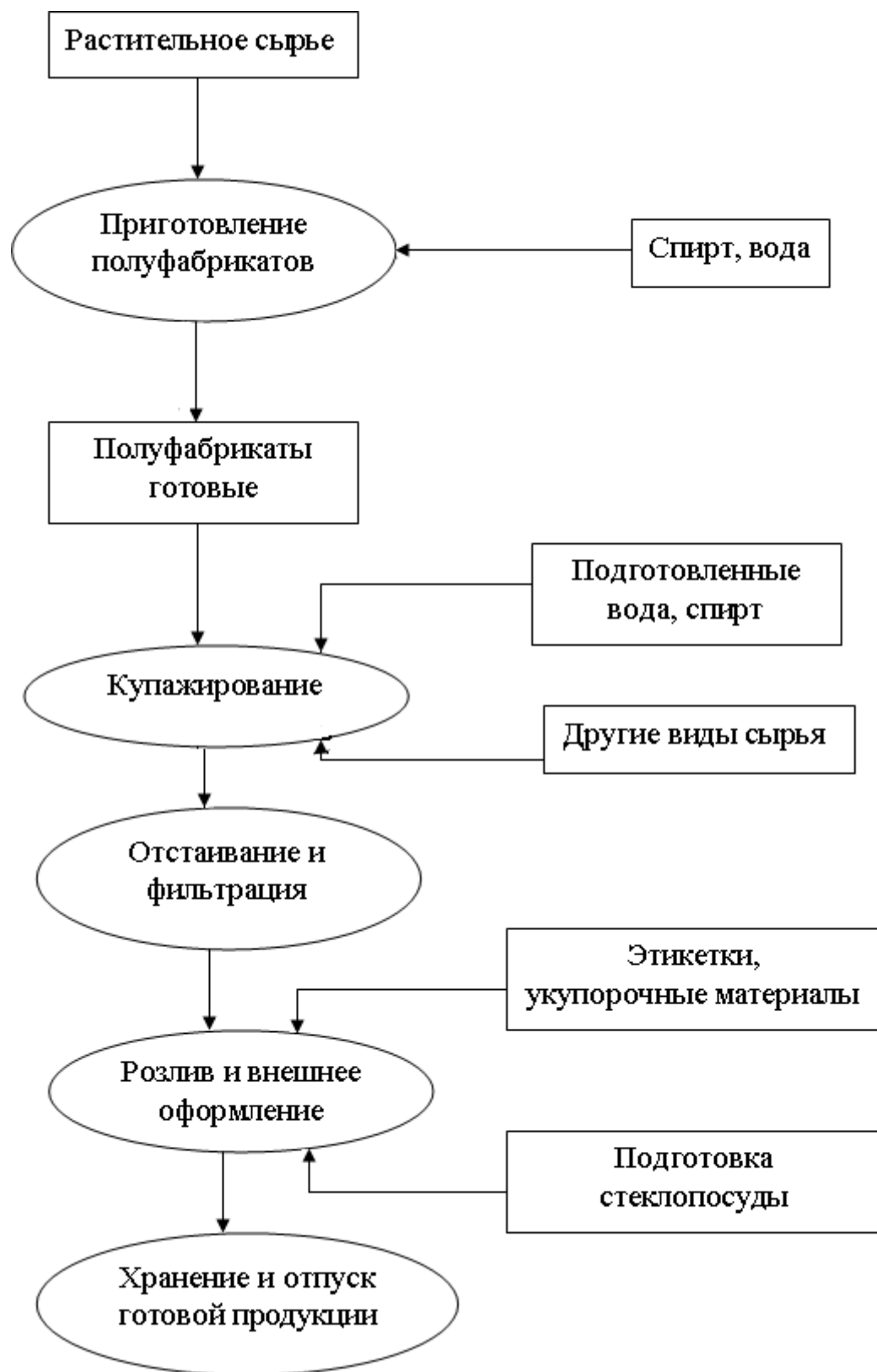
Рисунок 6 – Принципиальная технологическая схема производства ликероводочных изделий
