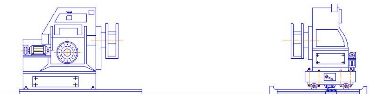
Рис. 2.4 - Конструктивная схема двухстоечного кантователя:
