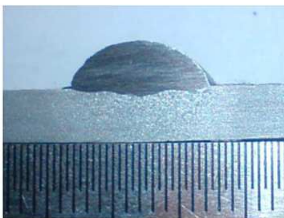
Рисунок 3.15 - Наплавка расщеплённым электродом.
