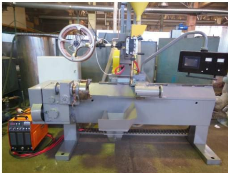
Рисунок 2.6 - Применение установки У653А для наплавки цилиндрических поверхностей
