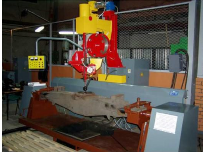
Рисунок 2.7 - Применение установки У653А для наплавки плоских поверхностей
