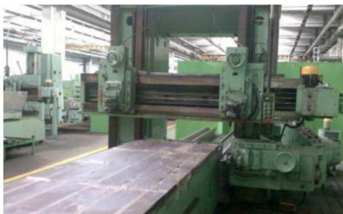
Рисунок 2.4 - Продольно-строгальный двухстоечный станок 7210
