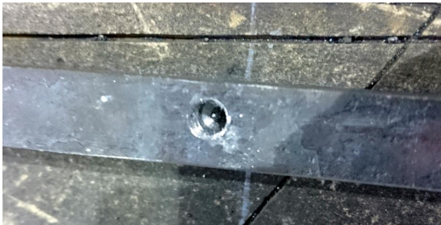
Рис. 77 – Нарезание внутренней резьбы
