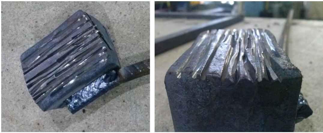
Рис. 68 – Штамп для прямоугольной рамки
