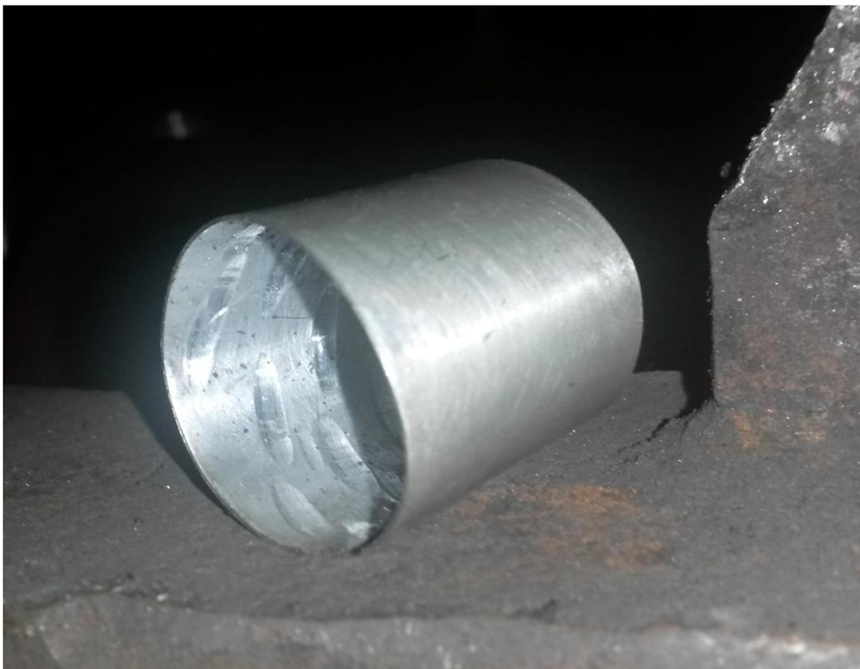
Рисунок 4.2 – Промежуточное кольцо с регулярным микрорельефом на внутренней поверхности
