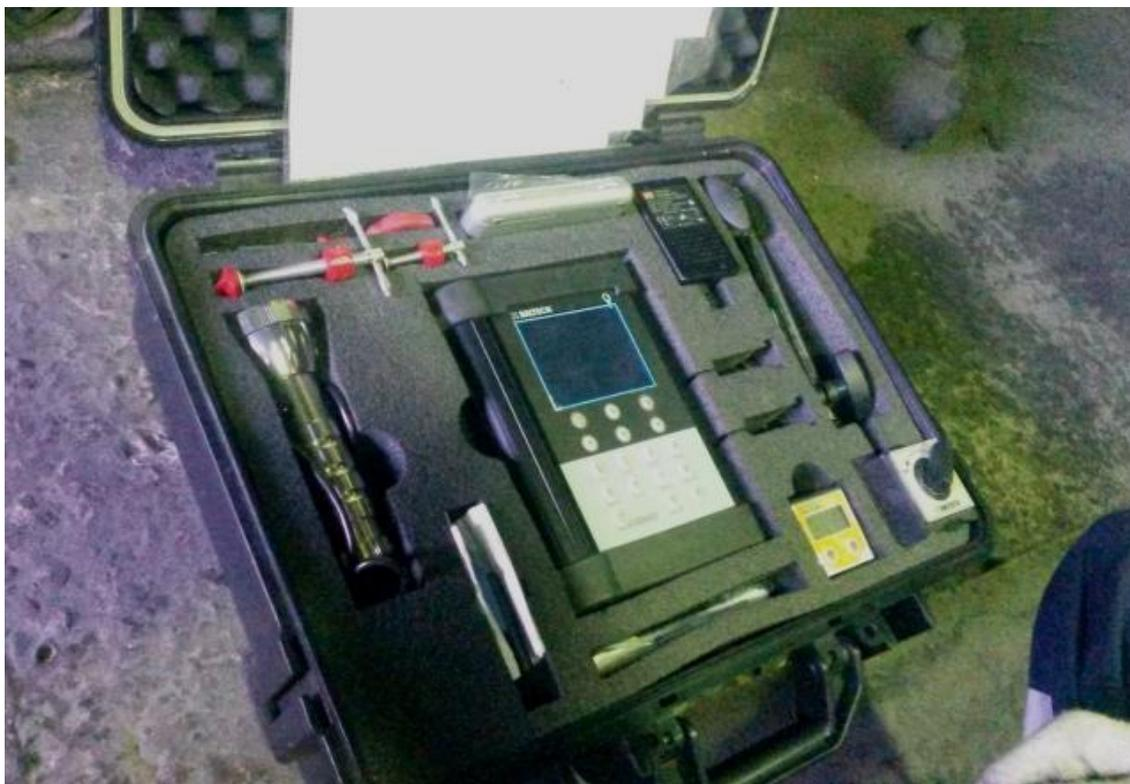
Рисунок 4.4 – Спектральный виброанализатор «BALTECH VP-3470»
