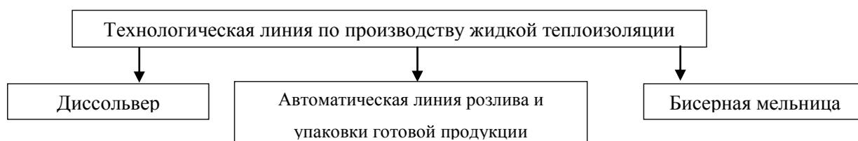
Рисунок 1 –Технологическая линия по производству жидкой теплоизоляции
