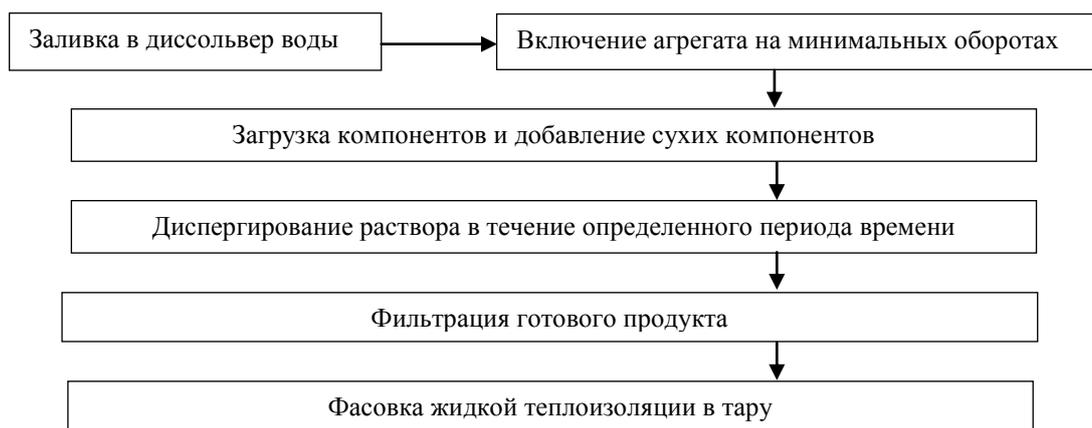
Рисунок 2 - Технологический процесс производства жидкой теплоизоляции
