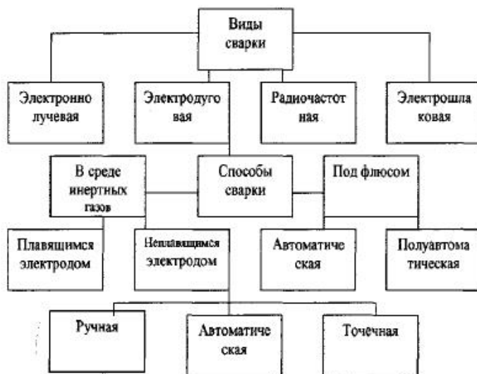
Рис. 1.4 – Возможные виды сварки титана
