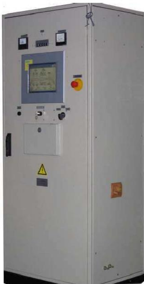
Рисунок 3.1 – Шкаф управления рельсосварочной машиной
