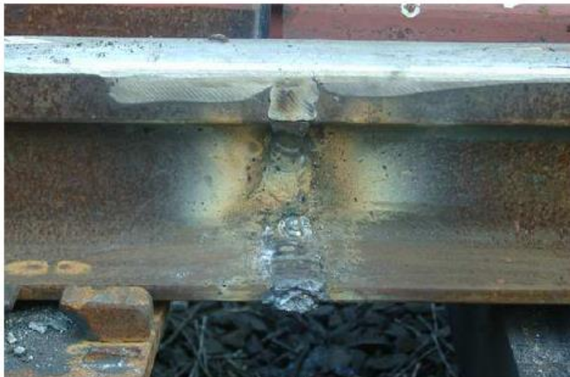
Рисунок 1.2 – Стык, сваренный дуговым ванным способом
