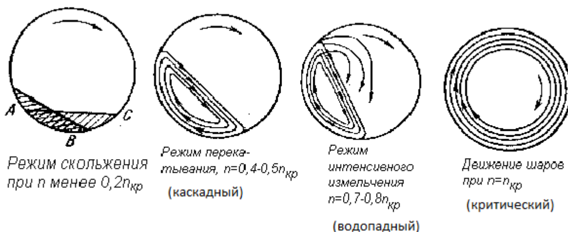
Рисунок 6.1 Режимы измельчения
