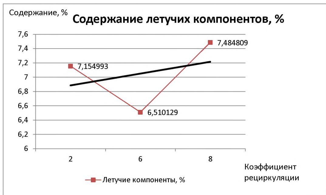
Рисунок 11 – Пример зависимости содержания летучих компонентов в коксе, полученном при температуре 500°C от коэффициента рециркуляции
