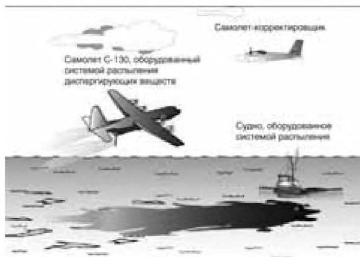
Рисунок 2 - Типовая надводная диспергирующая система ликвидации нефтяных разливов
