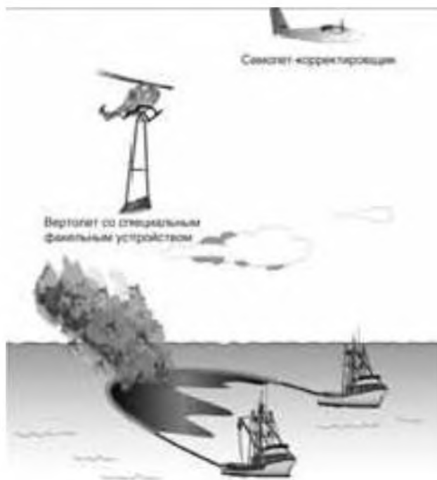
Рисунок 3 - Типовая надводная система сжигания нефти на месте нефтяных разливов
