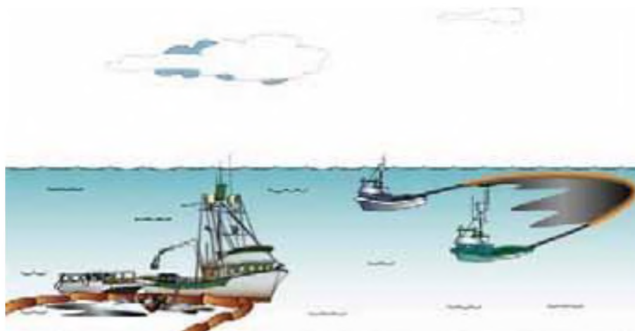
Рисунок 1 - Типовая надводная система механической ликвидации нефтяных разливов
