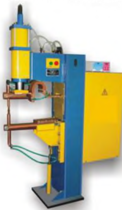
Рисунок 1.6 – Машина для контактной точечной сварки МТ-1928Л
