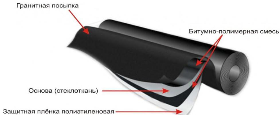
**Рисунок 1.2–Рулонный полимерно-битумный материал**
