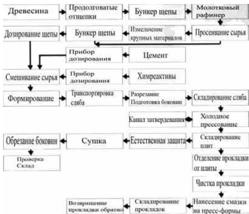
Рисунок 3 - Технология производства ЦСП-плит
