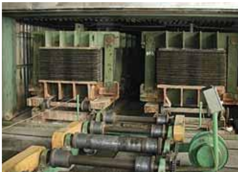
Рисунок 7 - Процесс выдерживания плиты до затвердения
