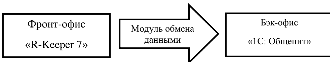
Рисунок 11 – Разработанная схема взаимодействия программных продуктов в ООО «Фортуна 2006»
