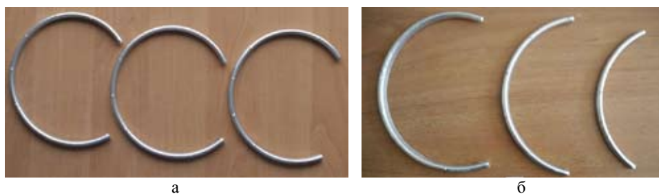
Рис. 1. Пробы жидкотекучести сплава АК12 в зависимости от нанесенного покрытия: а – серийное D1; б – разработанное KP80
