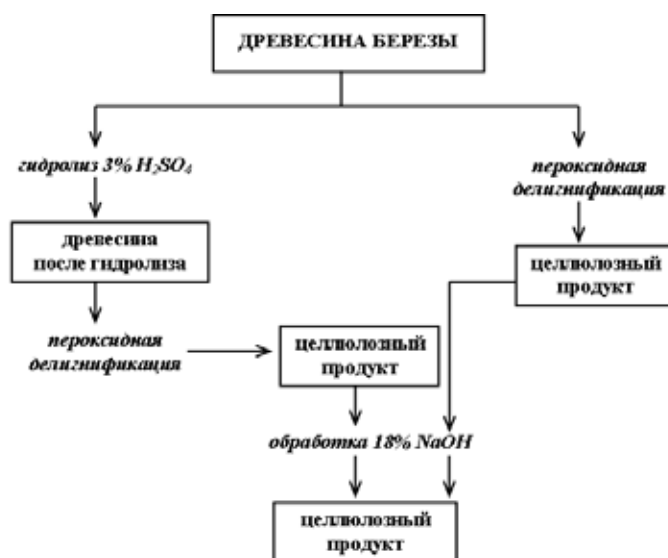
Рис. 1. Схема получения целлюлозных продуктов из древесины березы
