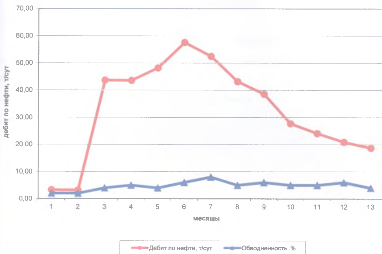
Рисунок 3.2 – Динамика изменения дебита и обводненности по скважине 217 после проведения ГРП
