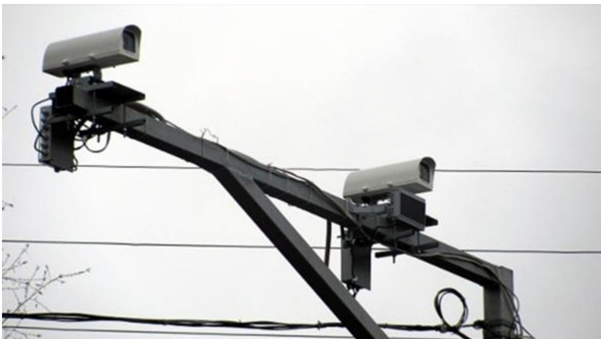
Рисунок 2.15 – Система видеофиксации нарушений правил дорожного движения «Одиссей»
