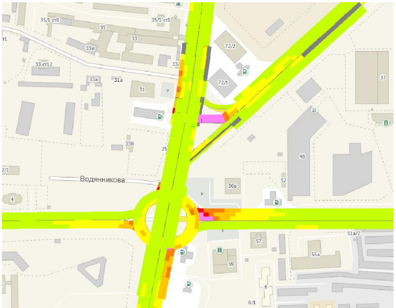
Рисунок 2.20 – Состояние транспортного потока при проектируемой ОДД с учетом перспективы на пересечении ул. Шахтеров – ул. Мужества – ул. Взлетная – ул. Молокова
