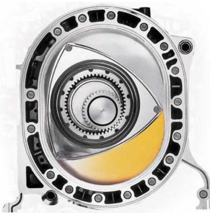
Рисунок 1.1 – Роторно-поршневой двигатель Ванкеля
